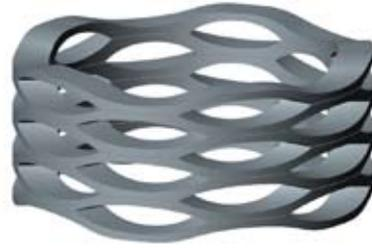
Les ressorts ondulés multispire sont fabriqués à partir d'un matériau de ressort plat et peuvent être utilisés dans des applications impliquant des dimensions de montage faibles. La longueur totale et la hauteur de travail d'un ressort ondulé multispire (inférieures à celles d'un ressort à fil rond classique) permettent une diminution des dimensions de montage jusqu'à 50 %.
