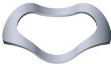
Les rondelles à ressort ondulées ont une capacité de ressort réduite et sont principalement utilisées pour éliminer tout jeu axial, par exemple contre un palier. Les rondelles avec  $D_y$  4,65-7,75 mm ont deux ondulations, les autres en ont trois.
